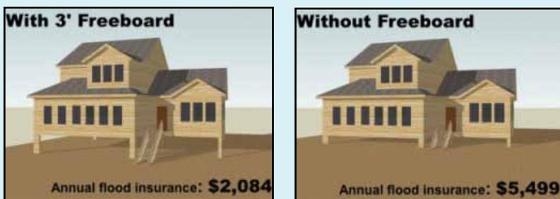
Figura 4. El subir un poco la altura de una vivienda tiene muy poco impacto sobre su apariencia. Fuente: Las Costas Storm Smart de Texas.
