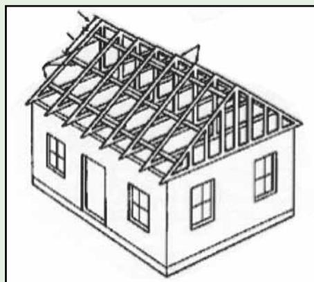
Figura 9. Para el refuerzo lateral, se colocan tirantes de 2 por 4 pulgadas a 18 pulgadas de la cumbre y se conectan a las partes horizontales que unen las armaduras opuestas. Los tirantes de 2 por 4 pulgadas se conectan con dos tornillos de 3 pulgadas #14 (A) y se superponen sobre dos armaduras (A y B). El extremo se conecta al hastial con un ángulo o soporte en L (C).
