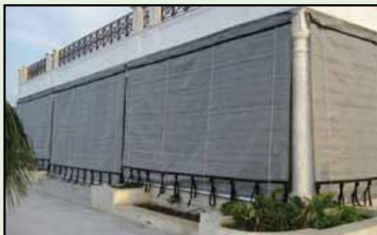
**Figura 25. Protección contra el viento de tela de tejido de esterilla de polietileno desplegada en el borde de un patio, que encierra toda el área. Fuente: Roll-a-way/QMI.**
